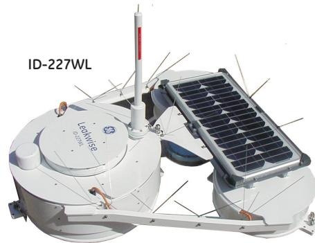
Şamandıra kafesi; detektörün alıcı anteninin dalga ve gelgit hareketlerine rağmen sürekli olarak su – hava kesitini korumasını sağlayacak şekilde tasarlanmıştır. Detektör su yüzeyinde 0,3 milimetre hidrokarbon tabakasını algılar ve bunun 20 milimetreye kadar olan gelişimini, güvenilir, sürekli ve hatalı alarm vermekzsiz izleyebilir.
